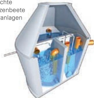
Schema einer Kleinkläranlage mit Abwasserbelüftung
